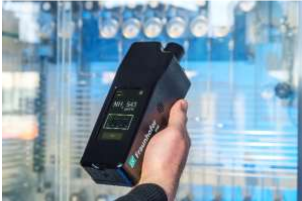
Abb. 3 Wasserstoff kann in Form von Ammoniak (NH 3 ) gespeichert und transportiert werden. Das Laserspektrometer des Fraunhofer IPM absorbiert die Wellenlänge von Ammoniak, reagiert deshalb sofort und zeigt das Ergebnis auf einem Display an.
